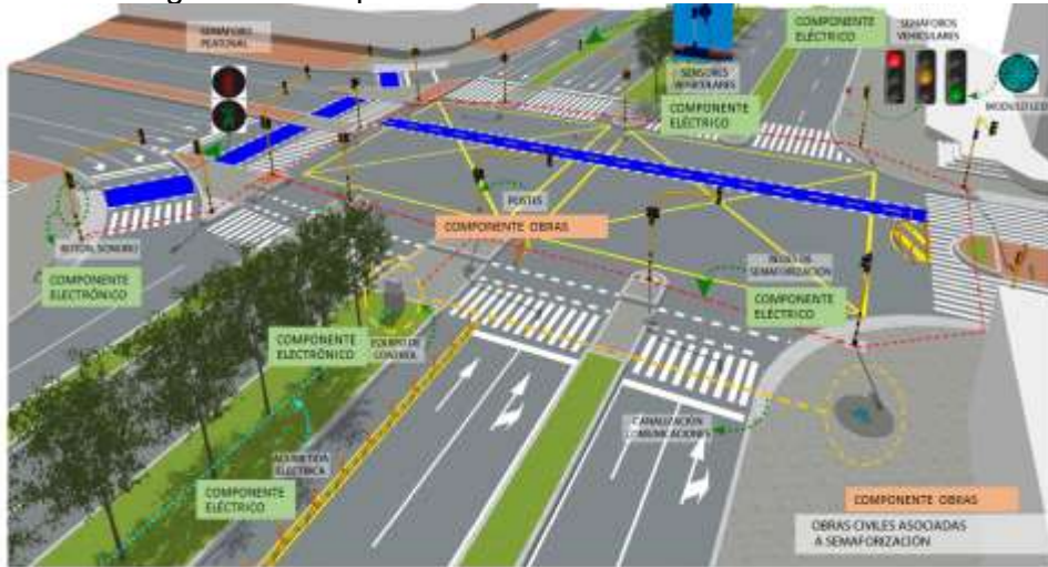
Figura 6 - Componentes de una intersección semaforizada
