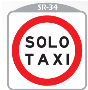
Imagen 6. Zona de estacionamiento de taxis SR-34.
