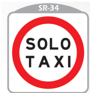
Imagen 6. Zona de estacionamiento de taxis SR-34.
